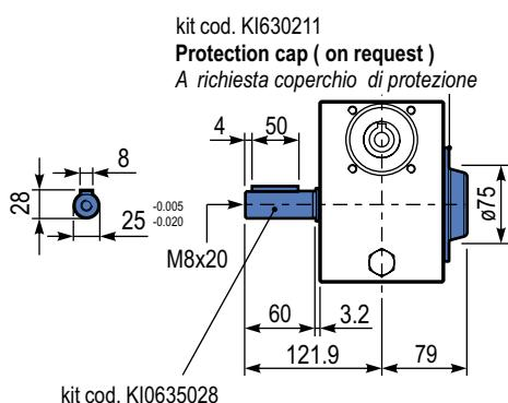
Riduttori a vite senza fine quadrati completamente in acciaio inox
